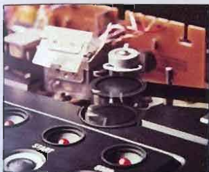
Schlitzfreies Einlegen des Tonbandes durch versenkbare Andruckrolle und hochschwenkende Kopfabschirmung
